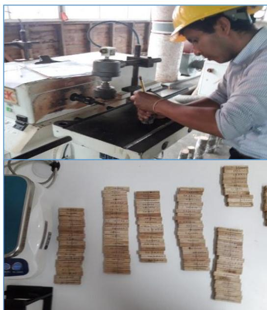
**Figura 1.** Análisis de las propiedades física y mecánicas de madera bolaina
