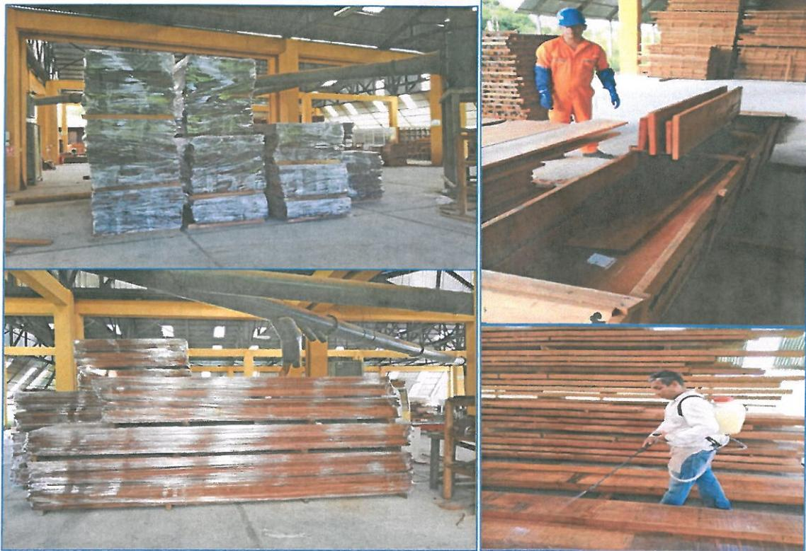
Fig 2. Preservado de madera y empaquetado de productos terminados con valor agregado.
