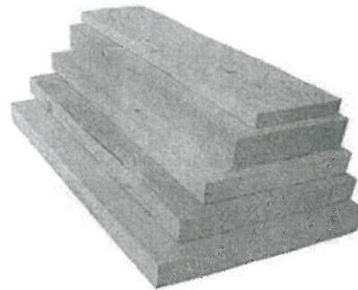
Figura 5. Apilado de tablas, previos al secado, en planta de segunda transformación
