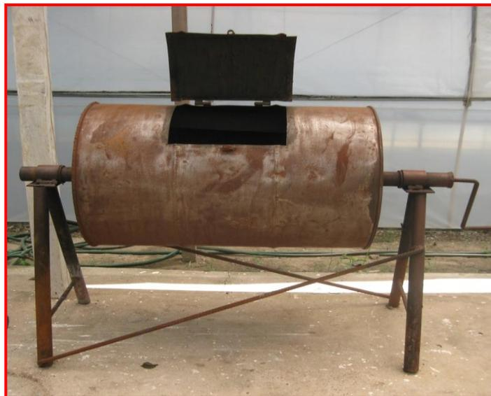
**Foto 5.** Quemador cilindro rotatorio.
