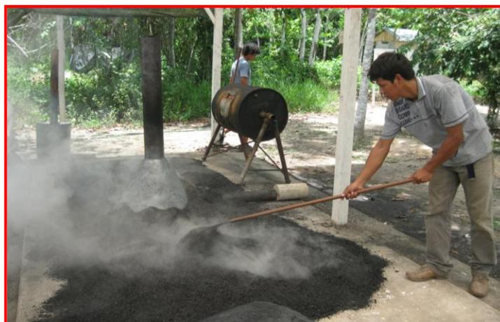
**Foto 11.** Separado de la cascarilla de arroz carbonizado.
