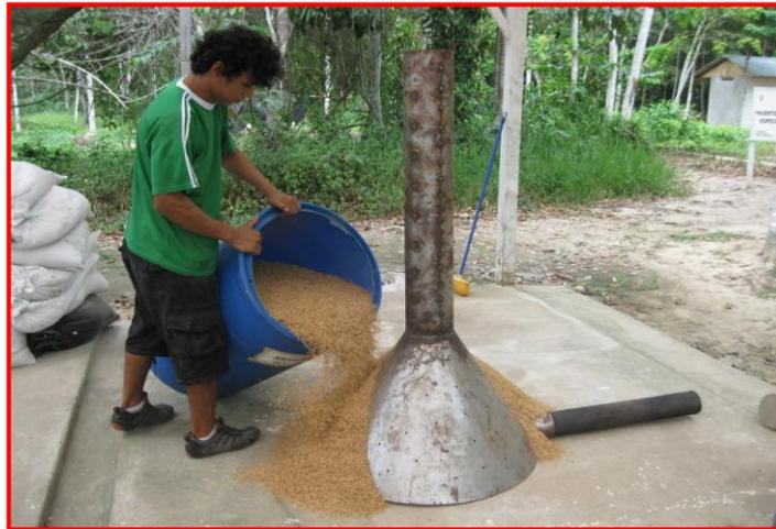
**Foto 8.** Puesta de la cascarilla de arroz sobre el quemador.
