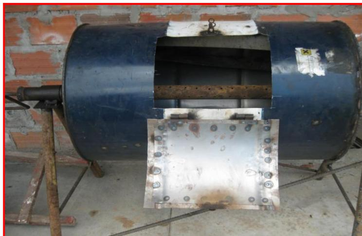
**Foto 3.** Compuerta de alimentación del quemador tipo cilindro rotatorio.
