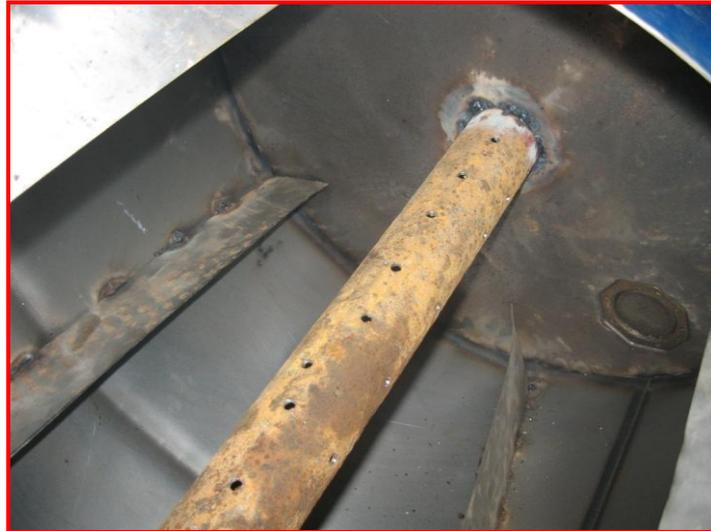
**Foto 4.** Paletas y respiradero interior en el quemador tipo cilindro rotatorio
