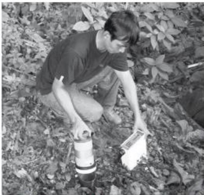
Foto 2. Medición flujo CO<sub>2</sub> del suelo con el analizador de gases EGM 4.
