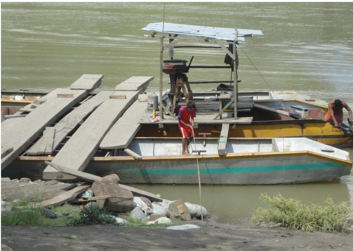
Foto 7: Plataforma metálica para el transporte de carros y motos, Llochegua
