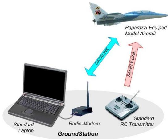
**SISTEMA DE ADQUISICIÓN REMOTA DE IMÁGENES MEDIANTE
