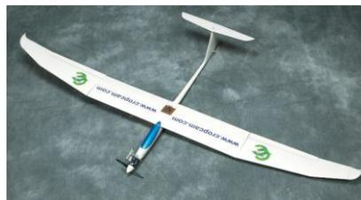
Es un modelo de radio control RC de alas fijas, diseñado para uso civil, monitoreo del medio ambiente y de forestación, equipado con un sistema de recepción Trimble GPS, y un piloto automático, el sistema de nave aérea no tripulado se puede operar manualmente y automáticamente, despegue y aterriza en forma automática en el mismo lugar donde despegue, proporciona imágenes de alta resolución con la
