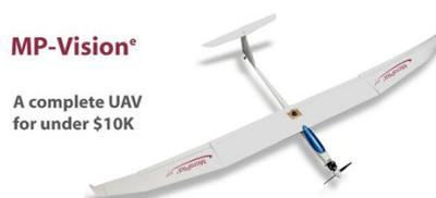
Es un modelo de radio control RC de alas fijas, diseñado para uso civil, monitoreo del medio ambiente y de forestación, equipado con un sistema de recepción Trimble GPS, y un piloto automático, el sistema de nave aérea no tripulado se puede operar manualmente y automáticamente, despegue y aterriza en forma automática en el mismo lugar donde despegue, proporciona imágenes de alta resolución con la ayuda de software en formato TIFF compatible con otros formatos convencionales
