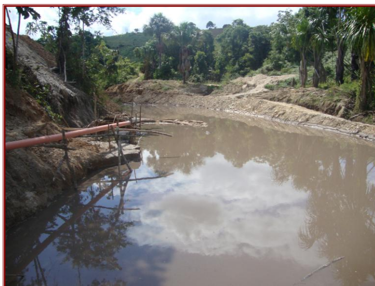
Foto 31. Poza de relave de los materiales o residuos dejados por la actividad aurífera dentro de una pequeña quebrada. Sector la Esperanza-distrito de Aucayacu, Julio 2010.
