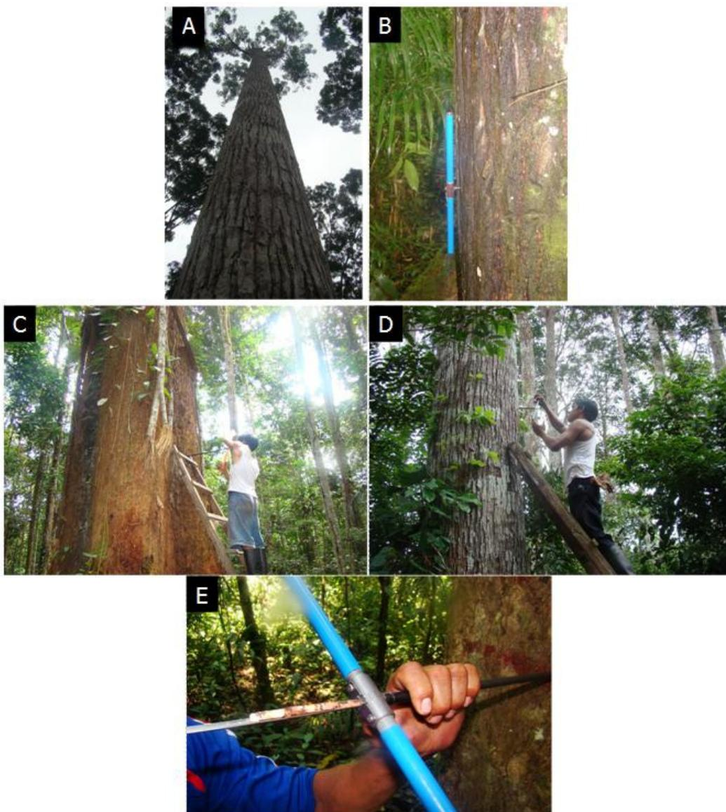
**Figura 6** Extracción de las muestras de leño en árboles de *Cedrelinga cateniformis*. (A) árbol de *Cedrelinga cateniformis*; (B) Introducción de la sonda en el interior del tronco a través del movimiento en el sentido horario; (C) y (D) extracción de las muestras; (E) Detalle de muestra extraída por la sonda Pressler.
