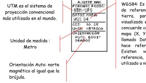
WGS84: Es un modelo matemático de referencia de la forma de tierra, para que la posición visualizada en la pantalla del GPS concuerde con las posiciones de un mapa (X, Y y Z para la altura) llamado Datum. El número "84" hace referencia al año 1984. Existen varios sistemas de referencia, el WGS84 es el más utilizado a nivel mundial.
